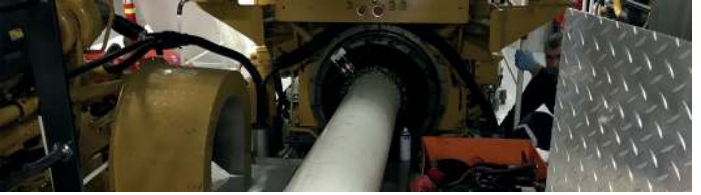
Azimuth Pervane Sistemi Kontrolü, Simplex-Seal Değişimi
