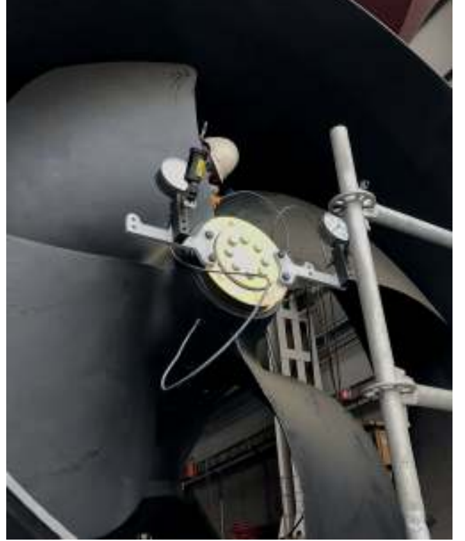
Azimuth Pervane Sistemi Kontrolü, Simplex-Seal Değişimi
